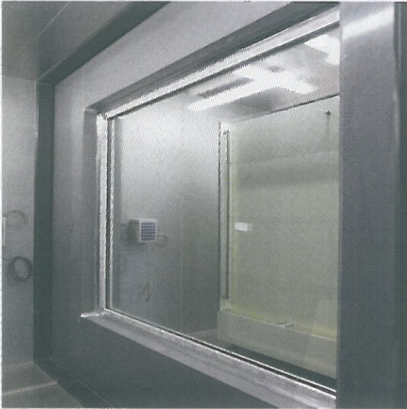
<사진 1> 열관류율 항온측 시험체 모습
