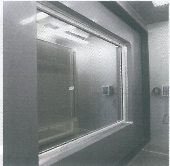
<사진 2> 열관류율 저온측 시험체 모습
